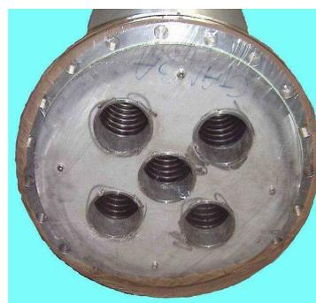
L'utilisation d'un fil de section triangulaire interdit tout colmatage du média filtrant
