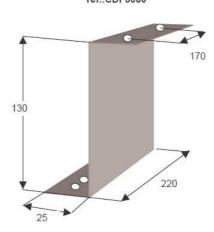
Les cyclones verticaux se fixent contre une paroi verticale à l'aide de deux pattes support en acier inoxydable et de deux colliers, également en acier inoxydable.
